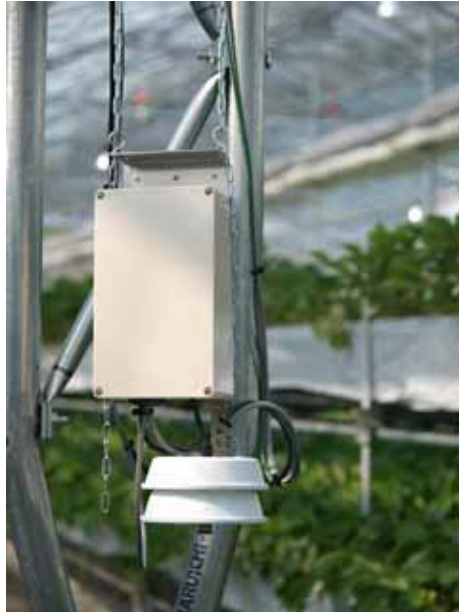
図9 大規模イチゴ生産ハウスにおける UECS 室内気象ノードの設置状況((有)エヌアイシステム林氏提供)
