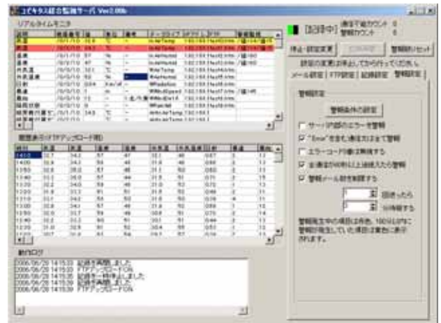
図 6 野菜茶業研究所の黒崎氏が開発した UECS の動作を監視し、メールや Web ページを使って報告する総合監視サーバ(星, 2007c)
