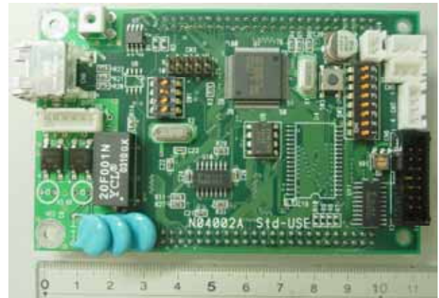
図2 UECS用に開発された低コスト組み込み用コンピュータ基板(USE) (星、2006b)
