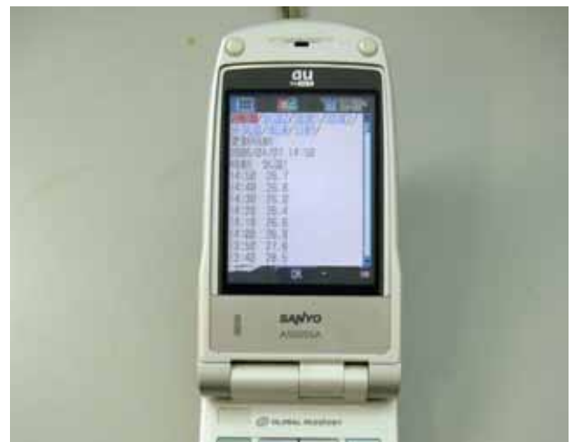
図 7 総合監視サーバが生成した Web ページを携帯電話に表示させて温室気温の遠隔監視を行っている例(星, 2007c)
