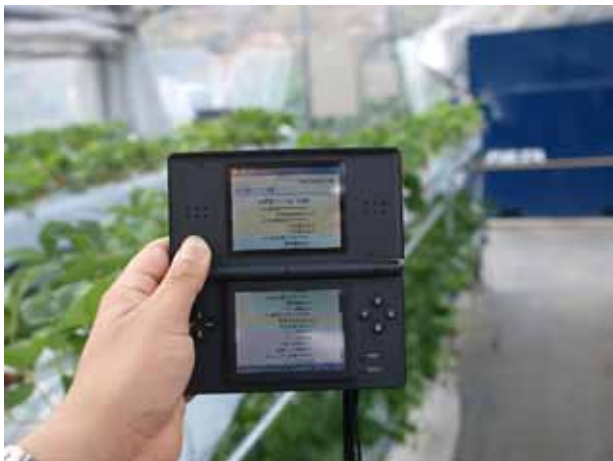
図 4 携帯用ゲーム機を使用して UECS の機器を遠隔操作している例(有)エヌアイシステム林氏提供)
